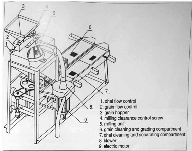
Fig. 2: Schematic diagram of dal mill
